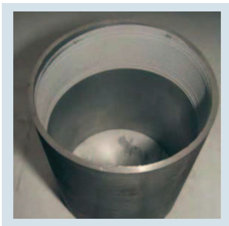
Рис. 15. Образец трубы внутренним диаметром 80 мм с покрытием из алюминия ( p_0 = 1,5 МПа, T_0 = 200 °С, генератор закрутки с 32 тангенциальными отверстиями диаметром 1,5 мм)
