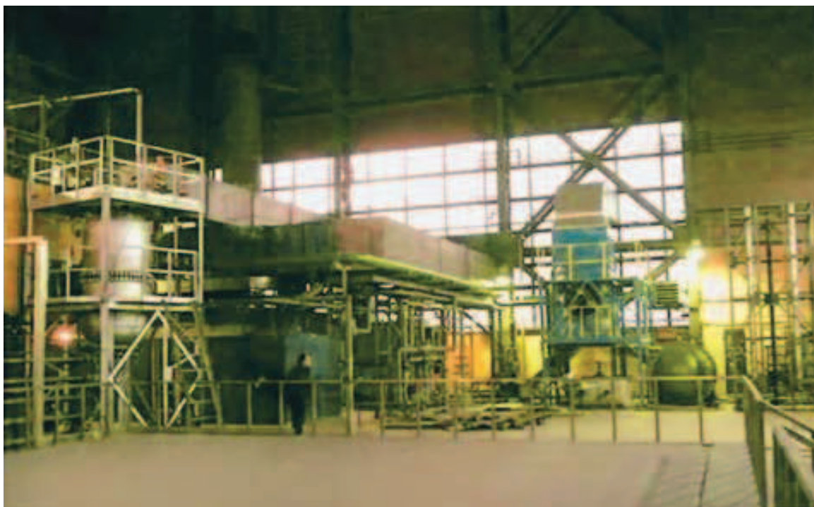
Рис. 21. Энерготехнологический комплекс совместного производства электроэнергии и синтетического жидкого топлива из природного газа на базе газотурбинной установки мощностью 1 МВт
